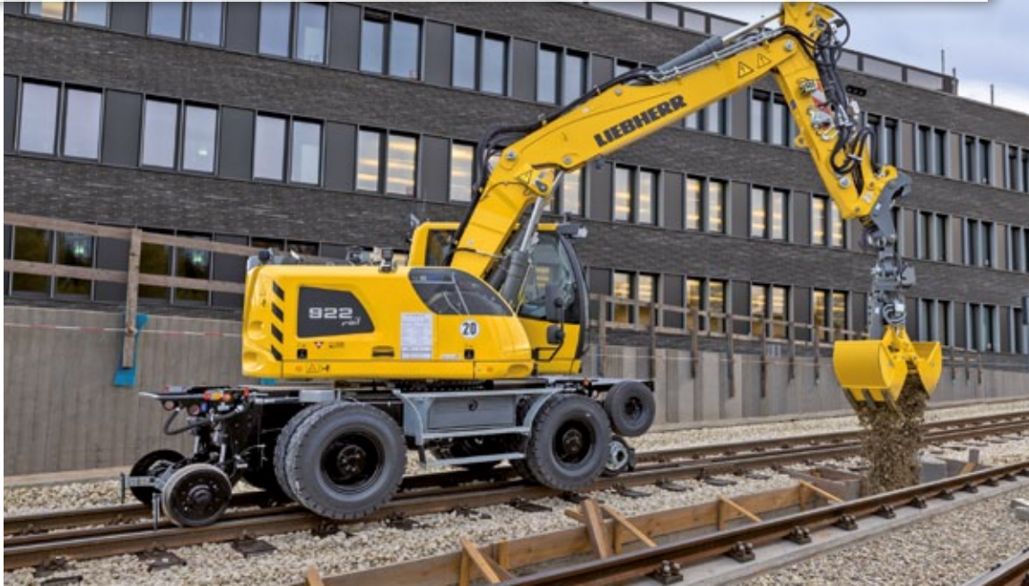
Der Zweiwegebagger A 922 Rail Litronic findet sowohl im Gleisbau als auch bei klassischen Erdbewegungsarbeiten Anwendung. Foto: Liebherr
