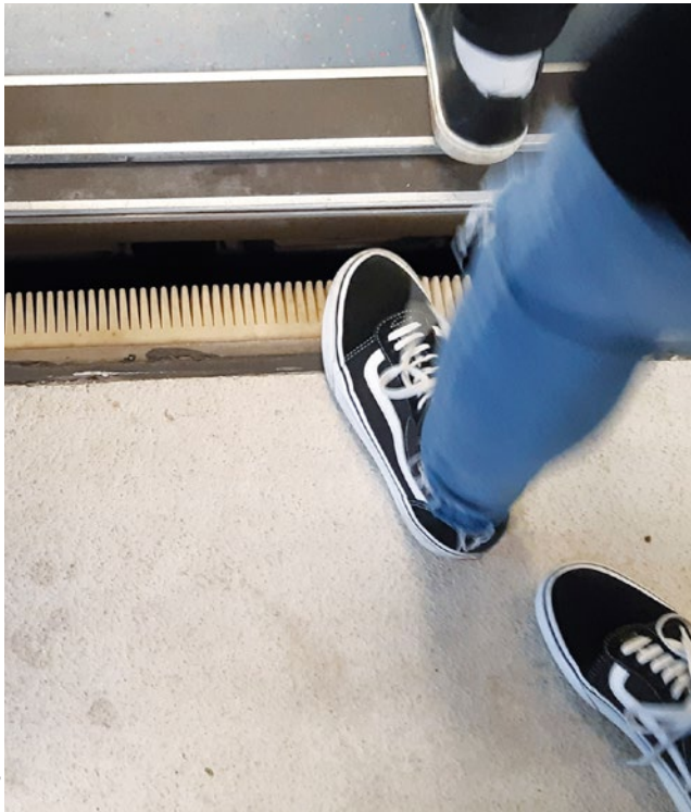
GAP-Filler for safe entry and exit of the train GAP-Filler für sicheres Ein- und Aussteigen aus dem Zug
