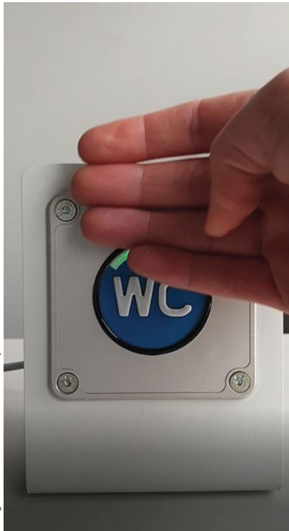
Pushbutton: wave or press without contact Taster: berührungstlos Winken oder Drücken
