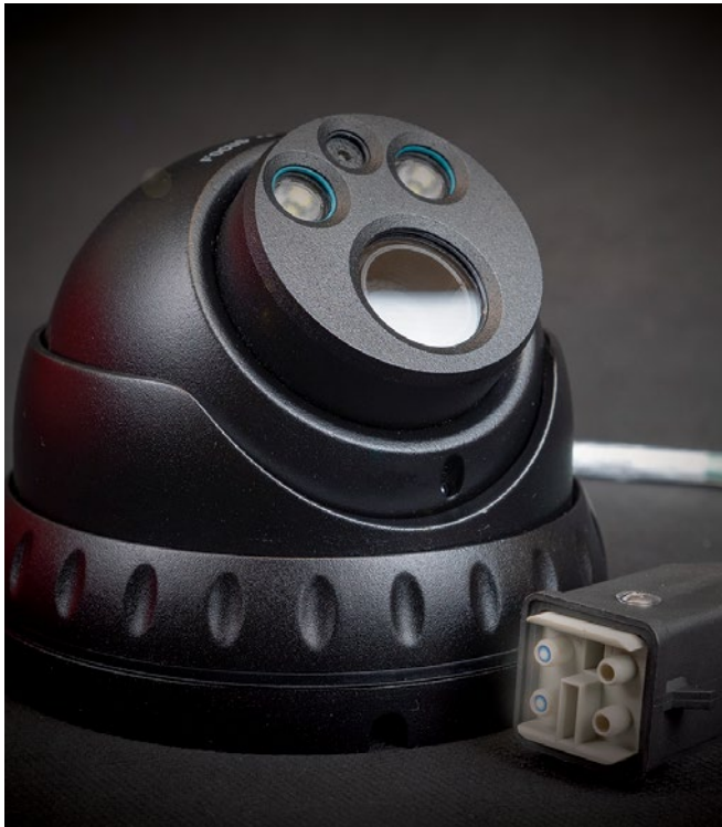
FiberCAMERA using fiber optic technology FiberCAMERA mit faseroptischer Technologie
