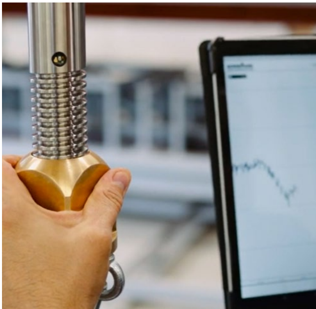
Smart screws transmit data wirelessly Smarte Gewinde übertragen Daten kabellos
