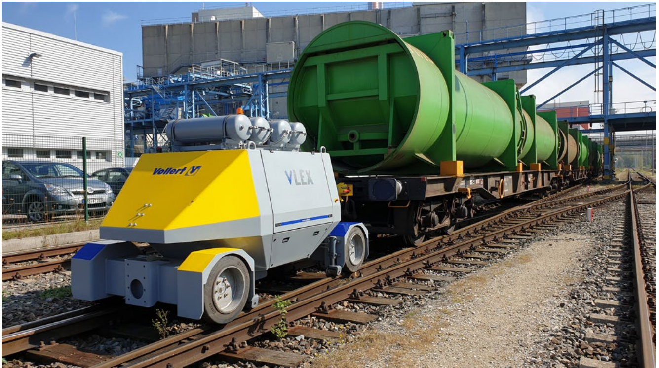
VLEX 40 – powerful and exhaust-free road-rail shunting solution VLEX 40 – abgasfreie Zweiwege-Rangierlösung für Schiene und Straße
