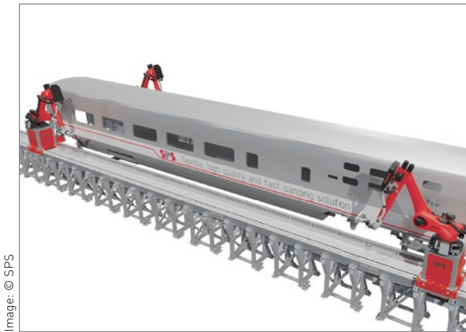
Automatic sanding of new and maintenance trains Automatisches Schleifen von neuen und zu wartenden Zügen
