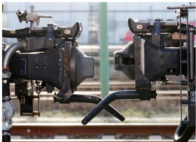
Type 4 DAC prior to coupling of the mechanical connection Typ 4 DAK vor dem Kuppeln der mechanischen Verbindung
