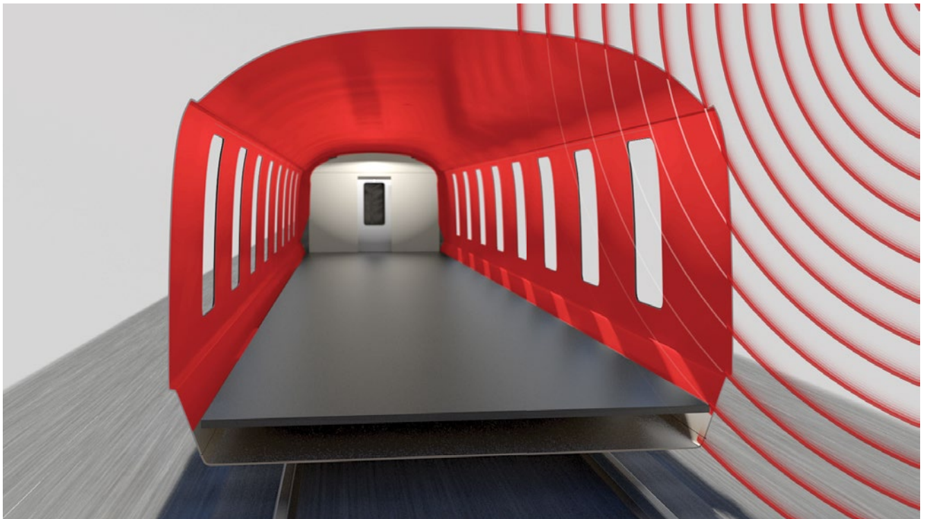
Empty passenger train car with damping material blocking soundwaves Leerer Personenzugwagen mit Dämpfungsmaterial, das Schallwellen blockiert
