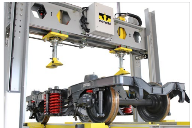
Nencki Bogie Test stand NBT with bogie Nencki Drehgestellprüfstand NBT mit Drehgestell
