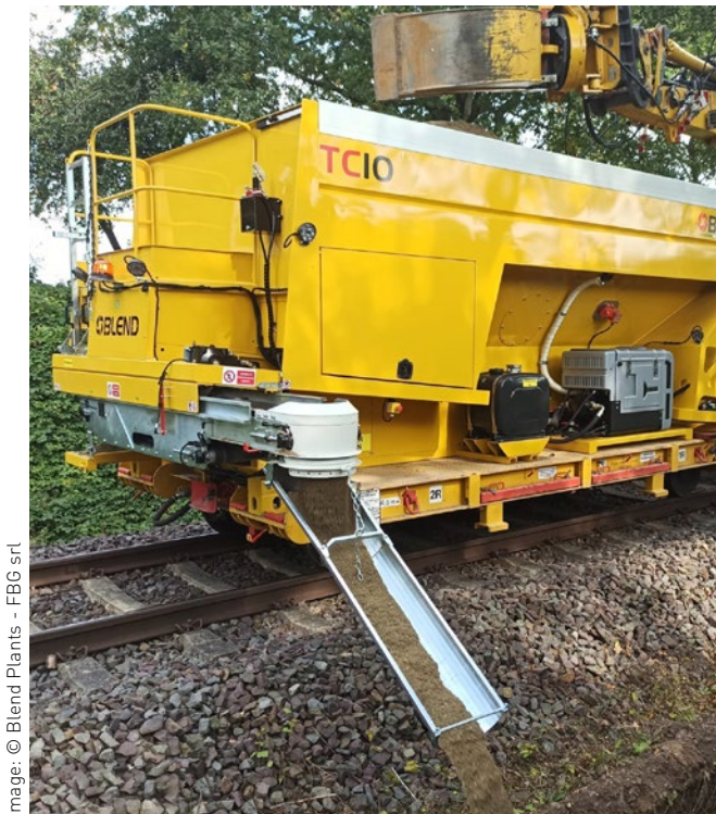
Blend TC10 discharges sand for cable covering Blend TC10 gibt Sand zur Kabelummantelung ab
