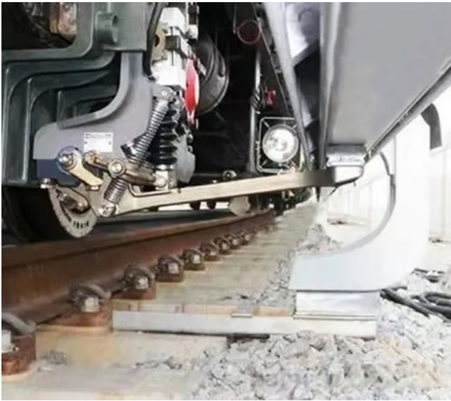
Collector shoe in urban rail traffic Stromabnehmer im Stadtbahnverkehr
