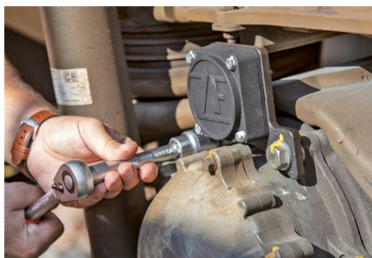
Die ZF-Sensoren befinden sich am Drehgestell des Versuchszugs.
