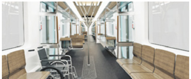
Plus de place pour les passagers dans le nouveau métro Inspiro de Siemens : l'intérieur des véhicules dispose d'un espace agrandi pour les places debout dans les passages entre deux voitures et d'un nouveau concept de places assises avec des portes élargies.
