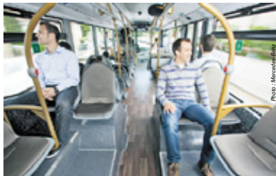
L'intérieur de l'autobus : Les mains courantes ont une forme ovale et sont en profilé filé en aluminium. Leur diamètre agrandi améliore la prise. La nouvelle forme permet par ailleurs d'intégrer des éléments lumineux, des insertions publicitaires modifiables et fixées par colliers de serrage et même de faire défiler des bandes publicitaires dans les mains courantes – une toute nouvelle forme de la publicité.
