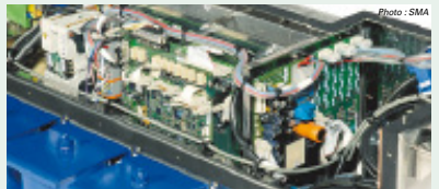
Les chargeurs de batterie SMA pour la plate-forme «Civity».
