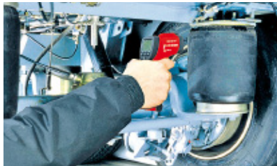
Mesurage à l'aide d'un transpondeur et pistolet-lecteur.
