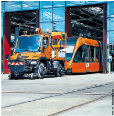
Unimog U 400 comme véhicule de service pour les tramways.
