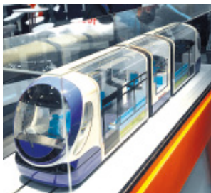
Kawasaki a présenté un véhicule ferroviaire à pile et à plate-forme surbaissée destiné au trafic urbain et suburbain.
