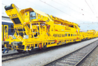
L'Eiffage Rail P100, le tout nouveau train de renouvellement à haut rendement P95 de Matisa.
