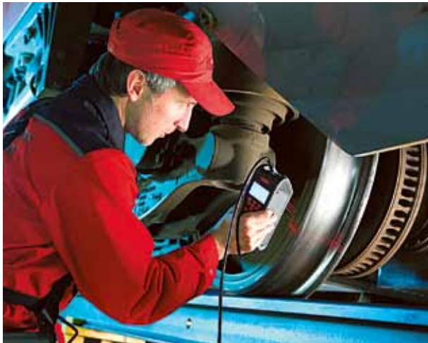
Das Messsystem Calipri-Wheel von NextSense arbeitet komplett berührungslos.
