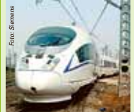
Einsatz in Fernost: Der CRH3 von Siemens schafft bis zu 350 Stundenkilometer.
