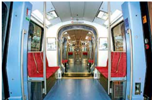
Blick in die neue Hamburger U-Bahn: Übergänge ermöglichen ein Durchgehen von Wagen zu Wagen.
