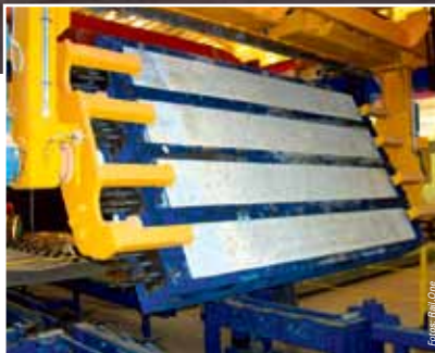
▲ Ausschalen der Schwerlastschwellen vom Typ AR 06.
