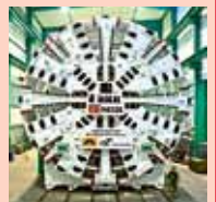
Die zehn Meter breite Tunnelvortriebsmaschine wurde eigens für den Kaiser-Wilhelm-Tunnel gebaut. Foto: DB AG / Adrian Siedler
