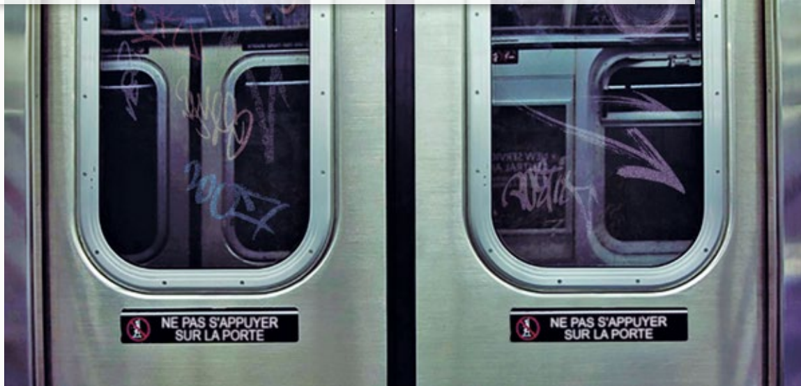
Die aufgebrachte Folie schützt das darunter liegende Glas vor Vandalismus.
