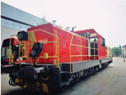
Rangierlok mit Hybrid AC-Antrieb
