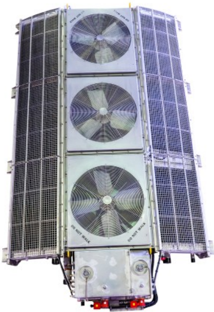
Radiatoreinheit in VLocity-DMU
