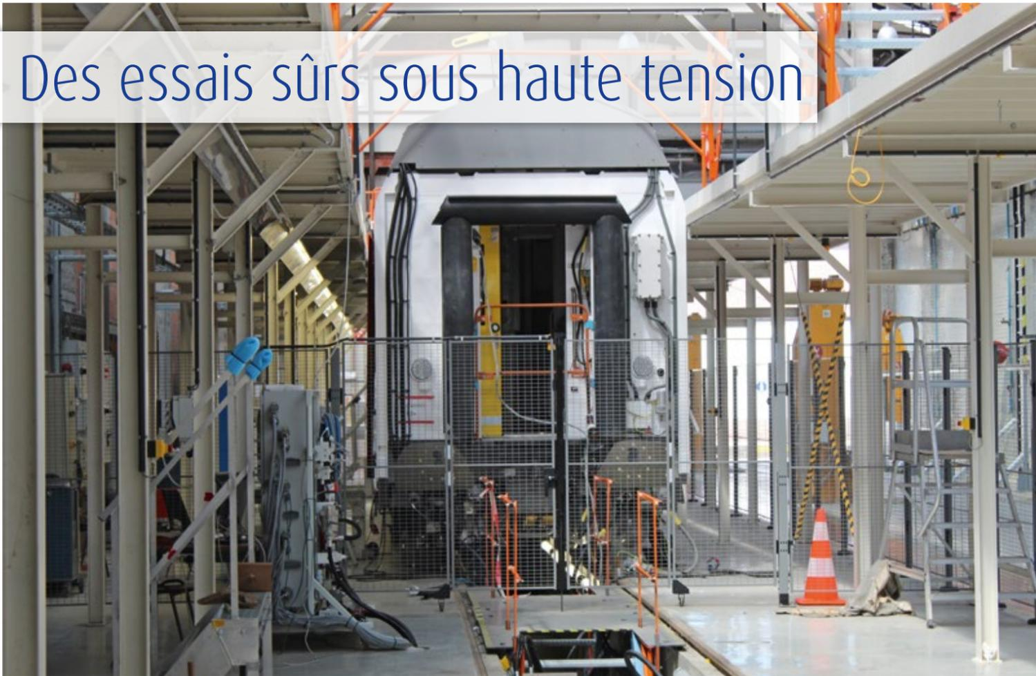
La sécurité avant tout : dans une cage d'essai, les véhicules ferroviaires sont soumis à des dizaines de tests fonctionnels et électriques.
